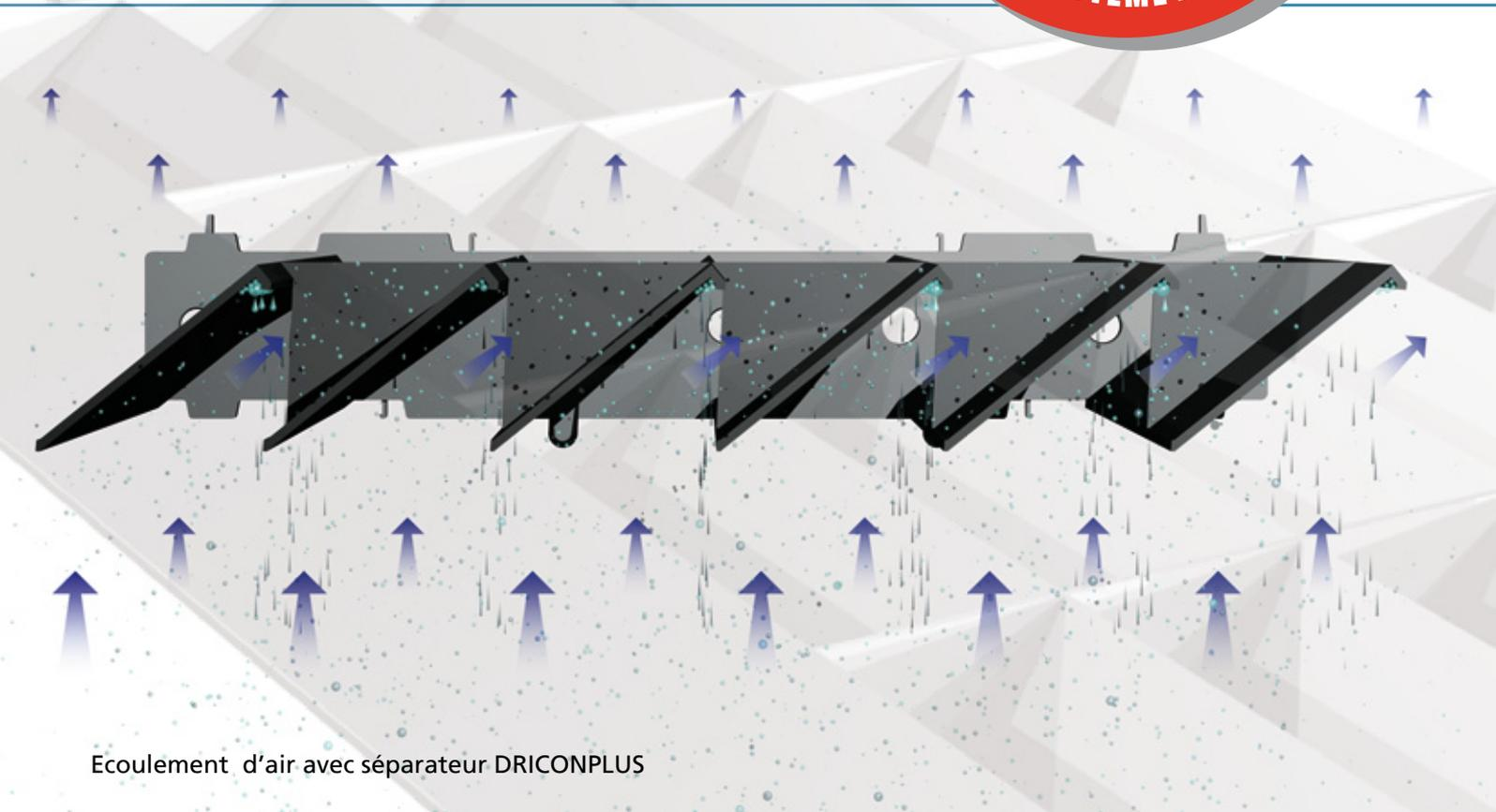
Écoulement d'air avec séparateur DRICONPLUS
